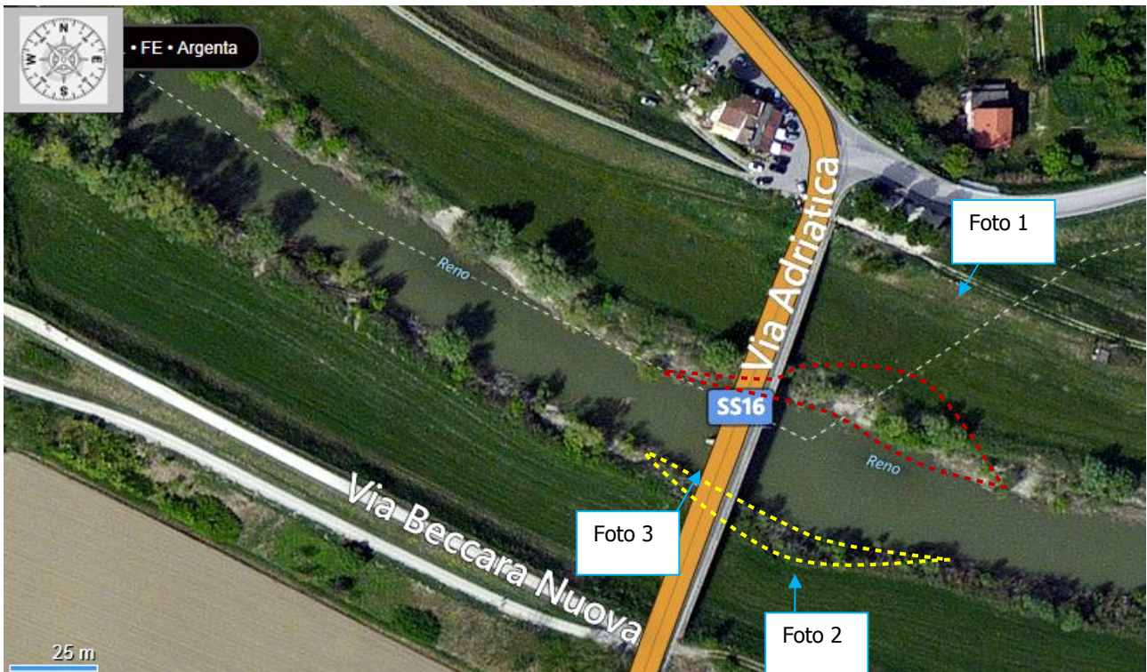
Fig. 8.2 - foto aerea (da Bingmaps 2011) del ponte Bastia (punto critico Ci1). Le aree tratteggiate indicano la dimensione del fenomeno erosivo che interessa le sponde dell'alveo di magra al 31/12/2013.
