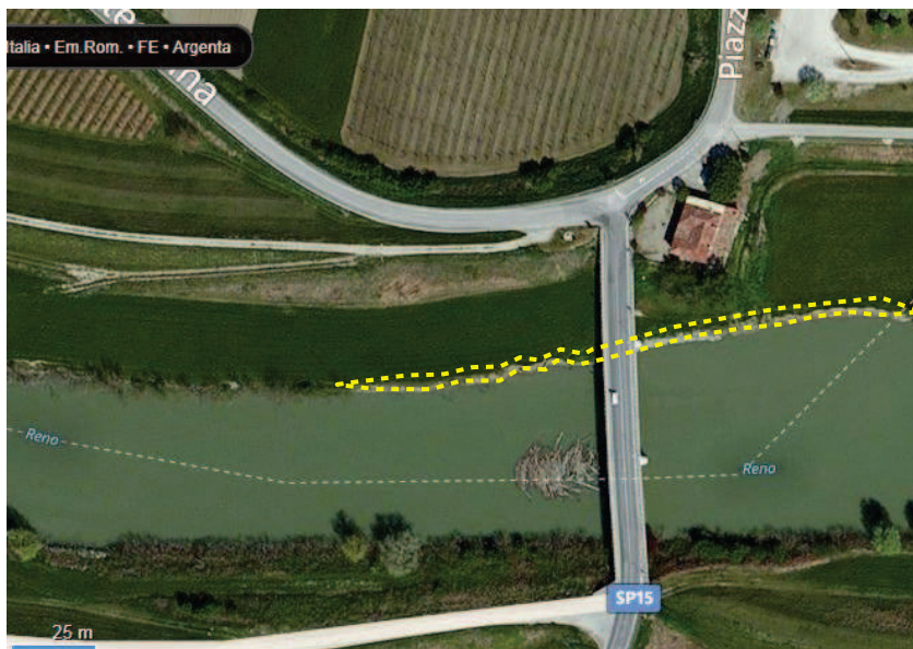
Fig. 8.8 -foto aerea (Bingmaps 2011) del fiume Reno (punto critico Ci), presso il ponte di via Raspona. In evidenza le aree in erosione e l'accumulo di detriti legnosi in prossimità delle pile del ponte.
